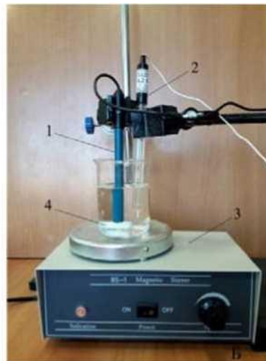
Рис. 2. Установка для определения концентрации (активности) хлорид-ионов в растворе. А: 1 — корпус датчика для определения Cl - -ионов; 2 — разъём MicroUSB для подключения к компьютеру; 3 — разъём BNC для подключения рабочего электрода; 4 — разъём для подключения электрода сравнения. Б: 1 — ионоселективный электрод (рабочий электрод); 2 — электрод сравнения (хлорсеребряный
