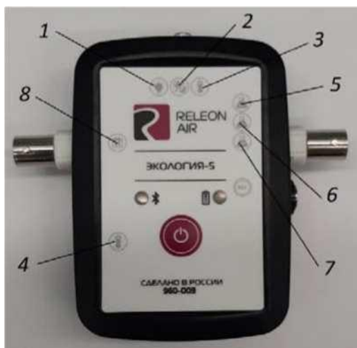
Рис. 2. Мультидатчик по экологии. Обозначение разъёмов и технологических отверстий: 1 — освещённость, 2 — относительная влажность воздуха, 3 — температура окружающей среды, 4 — температура растворов, 5 — нитрат-ионы, 6 — хлорид-ионы, 7 — pH,
