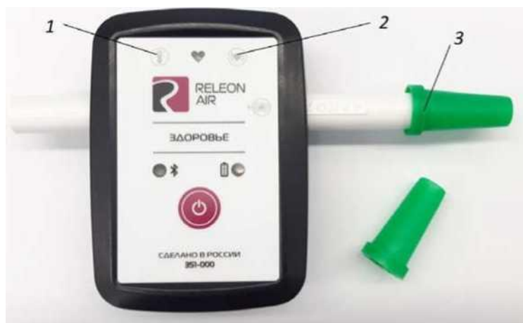
Рис. 3. Мультидатчик по физиологии. Обозначение разъемов и технологических отверстий: 1 — температура тела, 2 — пульс, 3 — частота дыхания (надет съёмный мундштук)
