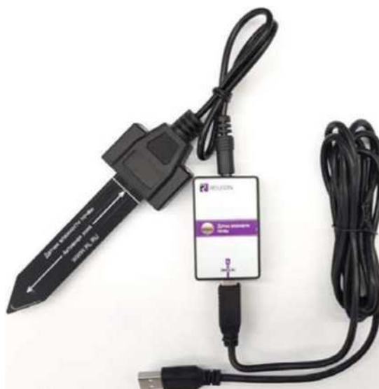
Рис. 4. Датчик влажности почвы Датчик электропроводности — предназначен для регистрации и измерения удельной электропроводности жидких сред, в том числе и водных растворов веществ. Применяется при изучении характеристик водных растворов, в том числе почвенных вытяжек.
